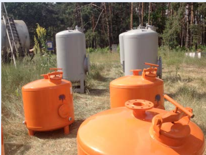
Піщані та вугільні фільтрувальні установки
